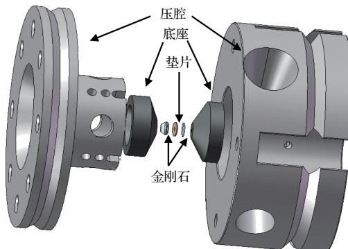
图1 静加载靶示意图
