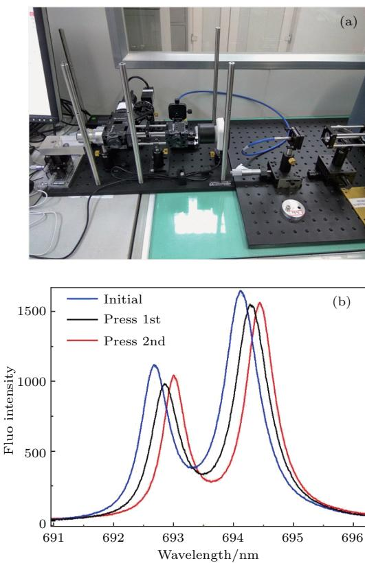
图3 (a) 红宝石荧光测压装置和(b) 红宝石荧光谱线
